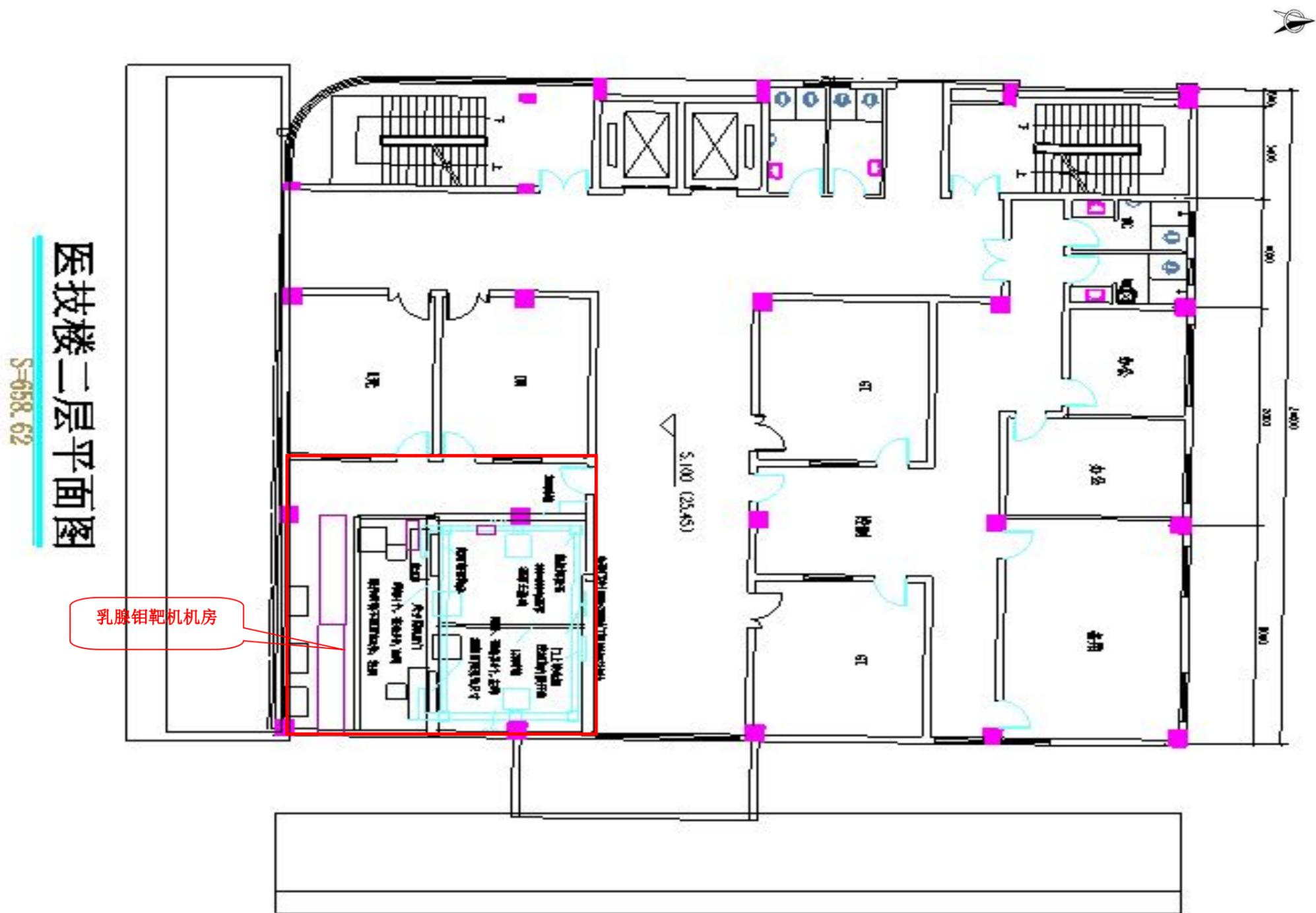
图 2-6 本次验收的本院乳腺钼靶机机房平面布置图
