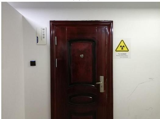
图 6-9 防护门电离辐射标志
